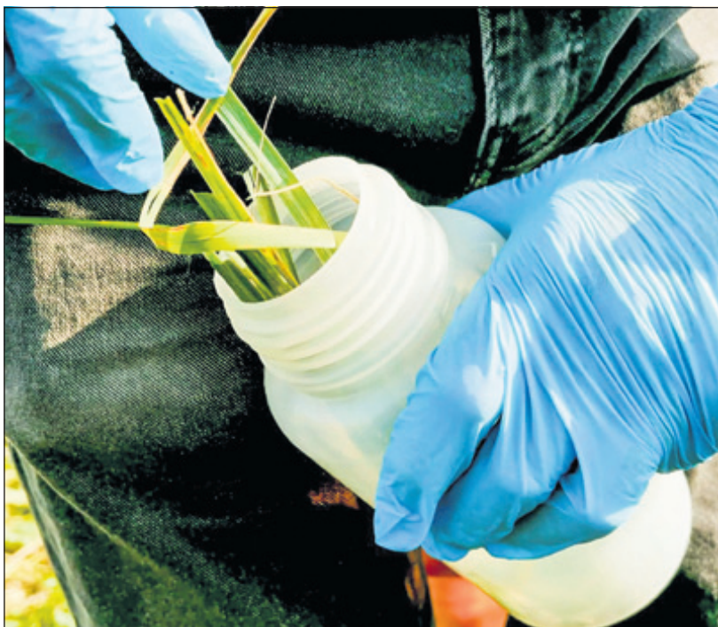
Obr. 4. Vzorek listů třtiny křovištní z okolí dopravní komunikace je odebírán do plastové láhve, kde je následně extrahován zředěnou kyselinou dusičnou.
