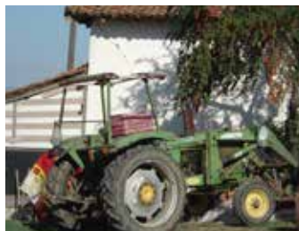
Traktor s rámem chránícím při převrácení
